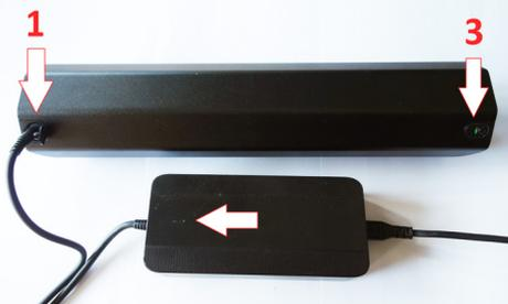
Mezi nabíjením a jízdou (vybitím) dodržte časový odstup alespoň 15 minut. Indikátor stavu nabití na baterii je jen přibližný a stav zobrazuje po zmáčknutí tlačítka na straně baterie (3). Kontrolka mění barvu od plného nabití – modrá, přes zelenou až po červenou- vybito. Baterii je možné nabíjet v kole i mimo něj, po vyjmutí z rámu.
