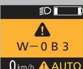
Chyba komunikácie s batériou. Očistite kontakty batérie a rámového dosedu - používajte na to nevodivé materiály! Ak sa problém nevyrovná, konzultujte so svojím predajcom.
