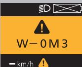
Chyba v komunikácii medzi ovládacím panelom a pohonnou jednotkou. Požiadajte svojho predajcu o opravu.
