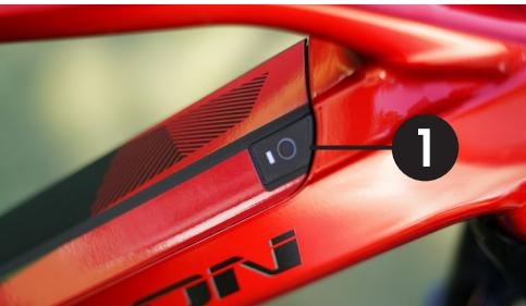
Batériu môžete vysunúť po odomknutí zámku na ráme do najzazšej polohy vľavo a následnom odskoku batérie z rámu. Sťačením aretačnej poistky na spodku batérie dôjde k uvoľneniu batérie, ktorú je možné následne vysunúť. Následne nabíjajte oddelenie od elektrobicykla. Pri zasúvani batérie zasuňte najprv hornú časť batérie s kontaktmi do rámu a následne priklopte a pritlačte spodnú časť [poistka sa zaklapne sama].
