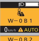
Preťaženie batérie, systém vstúpil do teplotného ochranného režimu. Znižte zrýchľovanie a pohybujte sa plynulejšie, aby ste znížili zataženie motoru. Po krátkom čase sa teplota vráti do normálu a asistencia bude obnovená.
