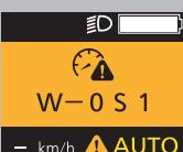
Snímač rýchlosi nesprávne detektuje signál. Vypnite a znova zapnite ovládací panel a skontrolujte polohu snímača a magnetu. Ak sa tým problém nevyrovná, porad'te sa so svojím predajcom.
